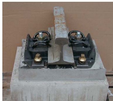
Abb. 12: Fertiggestellter Einzelstützpunkt DFF 300-1 mit Pagel Unterguss nach Einbauversuch
